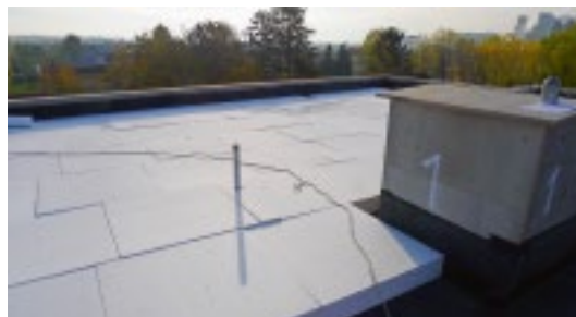
↙↙ Zukunftsweisende Gefällemessung mittels zwei Meter langer Messlatte, die auf Polystyrolzylinder mit zehn Zentimeter im Durchmesser aufgestellt wird.
